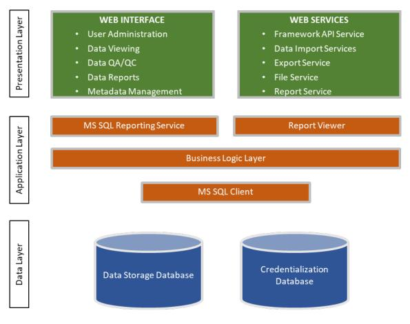
Figure 4-1. DMS Software Components.
